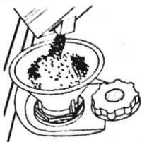
1. Ziehen Sie den Unterkorb heraus und schrauben Sie den Salzbehälterdeckel gegen den Uhrzeigersinn ab.
